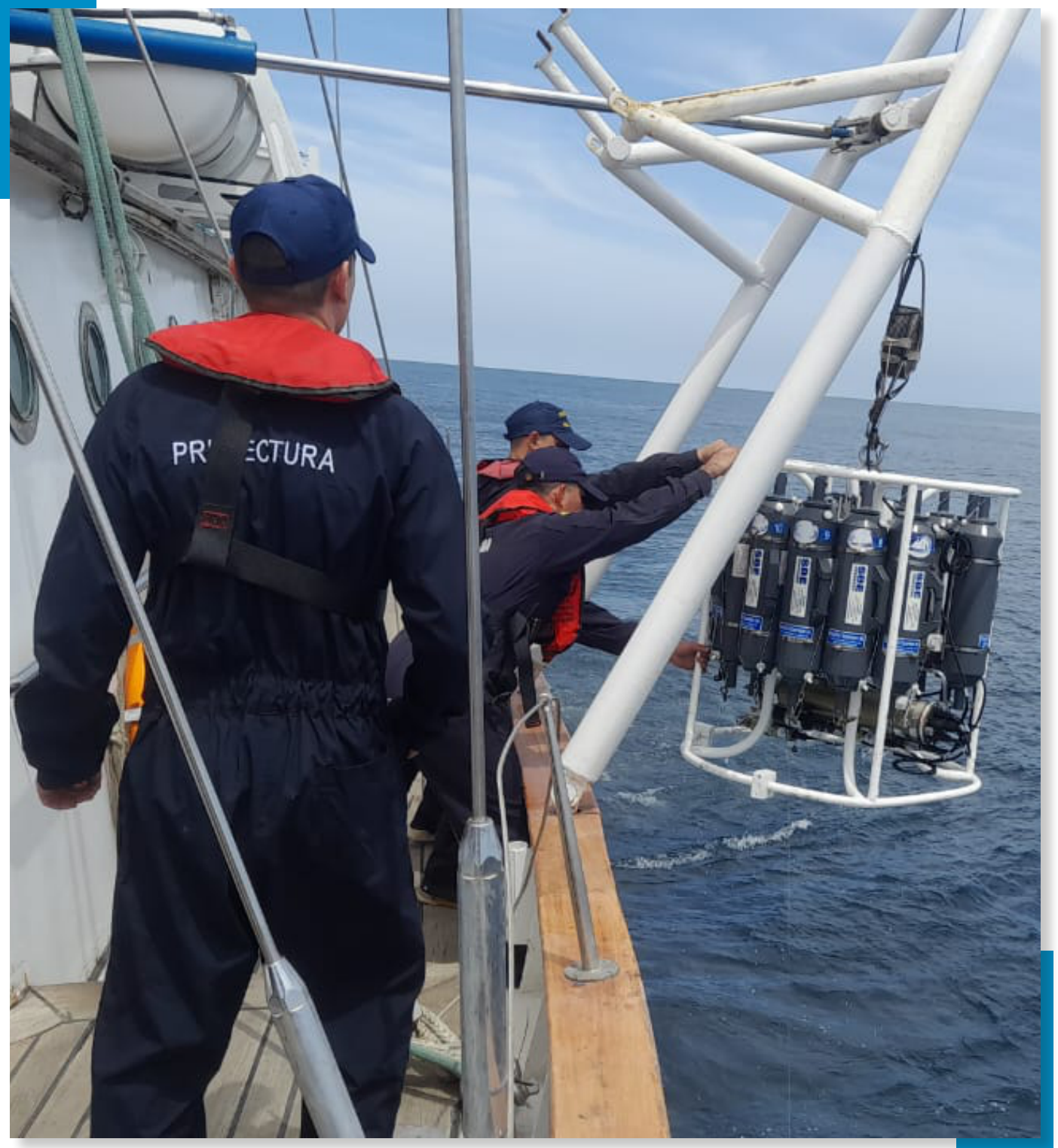
Imagen muestreo de columna de agua con roseta oceanográfica "Golfo San Matías"
