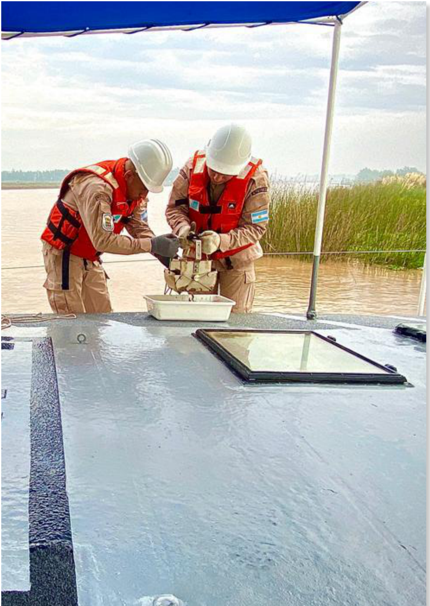
Imagen toma muestra de sedimento con draga
