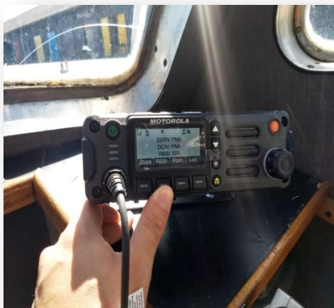
(Equipos Motorola APX 5500 instalado en Móvil CC-TT-22)
