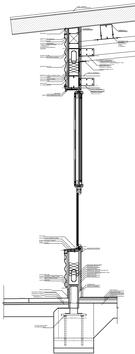
CORTE DETALLE AULA - EXTERIOR
