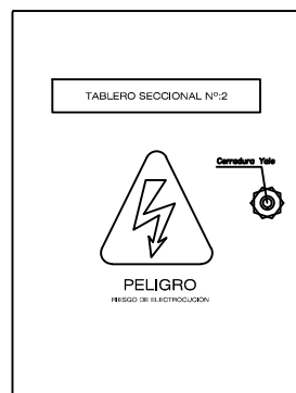
Vista frontal gabinete cerrado
