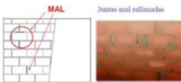
Figura 6.20. Especial cuidado con las discontinuidades en los morteros de pega. (Fuente: IETcc-CSIC, 2009)
