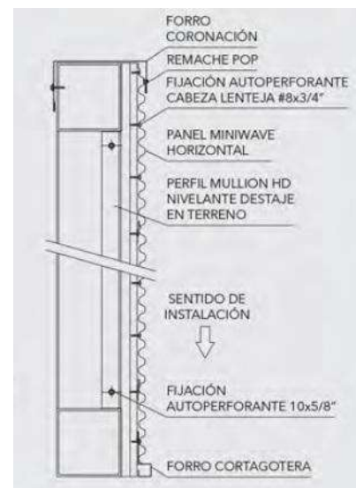
ESQUEMA DE COLOCACIÓN DE CHAPA SINUSOIDAL
