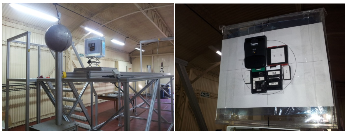
Figura 1. Plataforma y geometría de irradiación.
