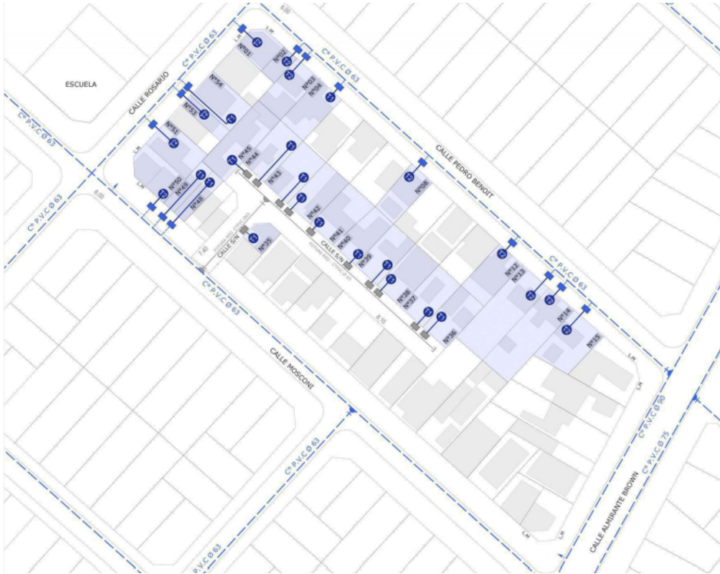
Plano Cortes. Conexiones domiciliarias - Intralote (agua)
