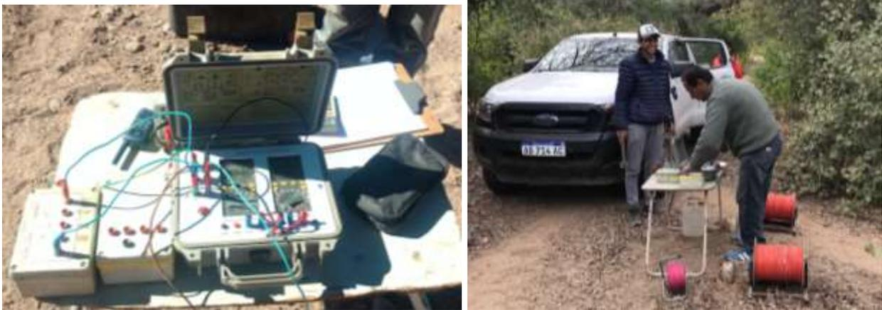
FOTO 1 Y 2. Equipo de geoelectrica.
