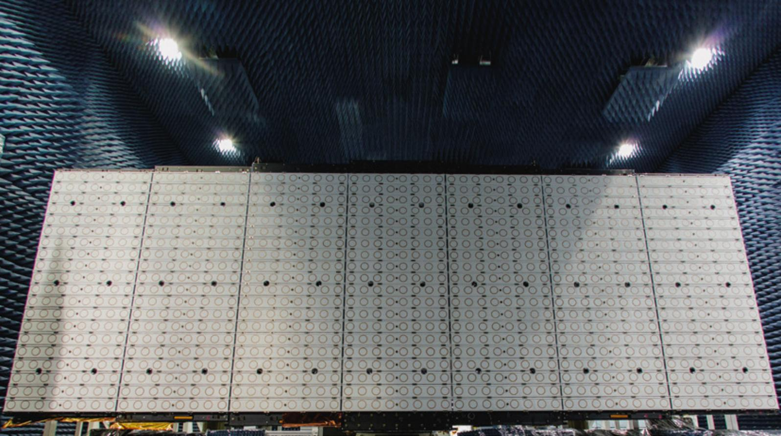
Antena radar SAR del satélite SAOCOM 1A en Cámara Anecoide del Laboratorio de Integración y Ensayos (LIE)/CETT. Córdoba. Argentina.
