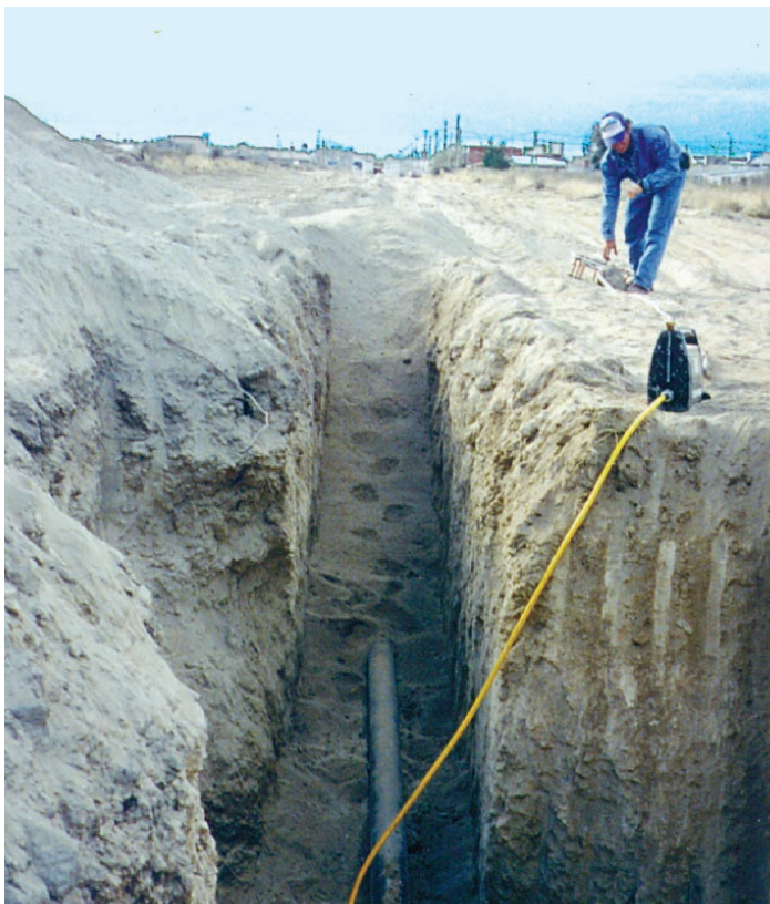
| Gammagrafía de una tubería
