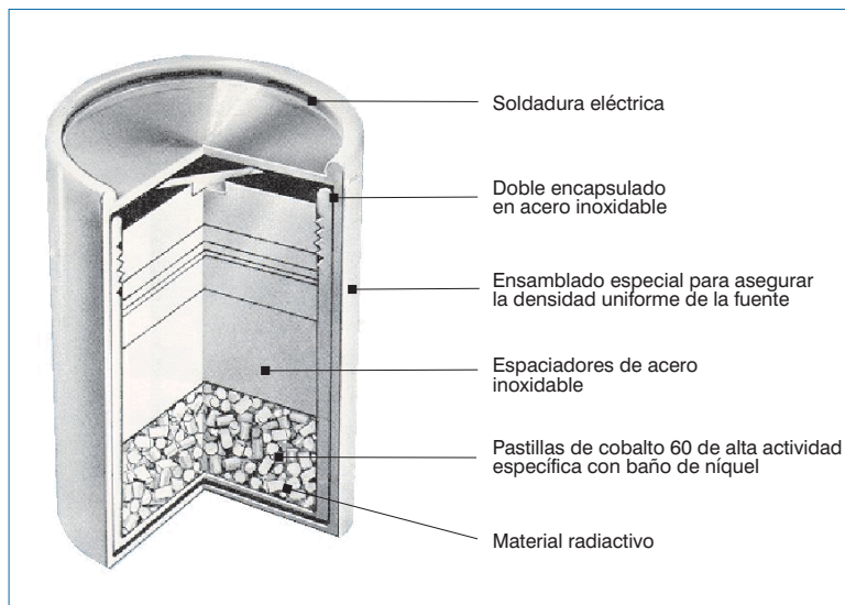
Figura 4. Esquema de fuente de Cobalto 60
