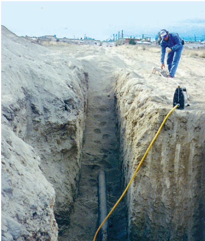
| Gammagrafía de una tubería
