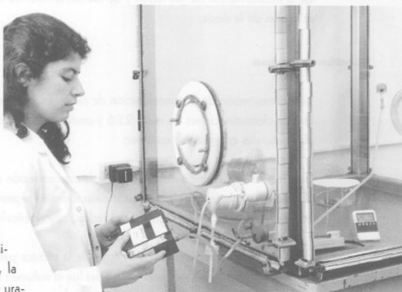
nio extraído del Complejo minero fabril Malargüe, provincia de Mendoza. La cámara consta de equipamiento para control de temperatura y presión, y para variaciones de humedad (10% a 95%), concentración de radón (desde  $450 \text{ Bq/m}^3$  hasta  $3500 \text{ Bq/m}^3$ ), progenie y aerosoles, para la realización de pruebas en diferentes condiciones ambientales. La concentración de radón de la cámara fue calibrada por el método de Lucas.
