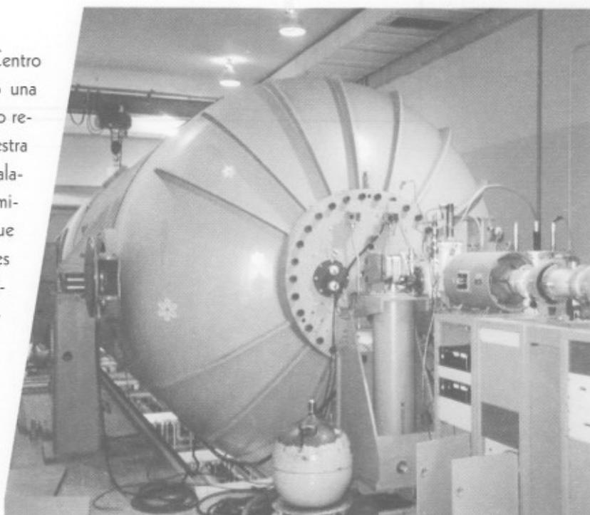
Dado que la instalación será dedicada al análisis de compuestos moleculares de actínidos, los imanes inyector y analizador deben poseer campos magnéticos y resoluciones que permitan doblar y resolver esas masas pesadas.
