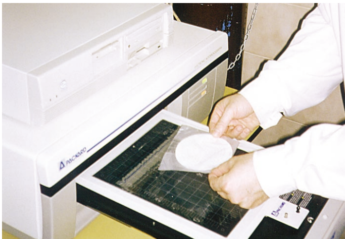
Identificación de partículas en un filtro por el sistema de autorradiografía electrónica
