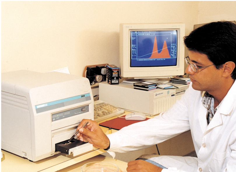
Medición de detectores termoluminiscentes (TLD)
