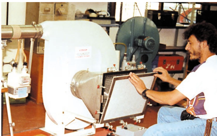
Banco de prueba de filtros
