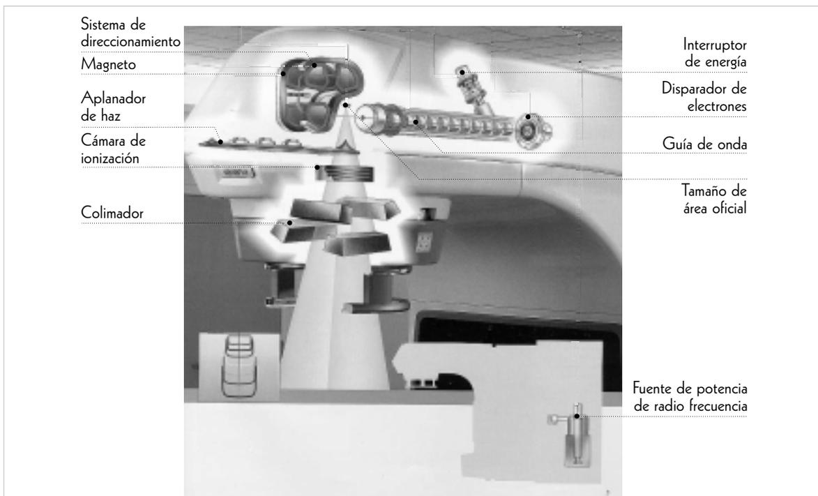
Los equipos de teleterapia se instalan en recintos apropiadamente blindados. Los diseñadores y constructores proveen los equipos de teleterapia pero es responsabilidad del usuario proveer la instalación para el tratamiento. Los fabricantes sólo especifican los servicios eléctricos y auxiliares requeridos, algunas características del recinto y sugieren los dispositivos de seguridad e interlocks compatibles con el equipamiento.
