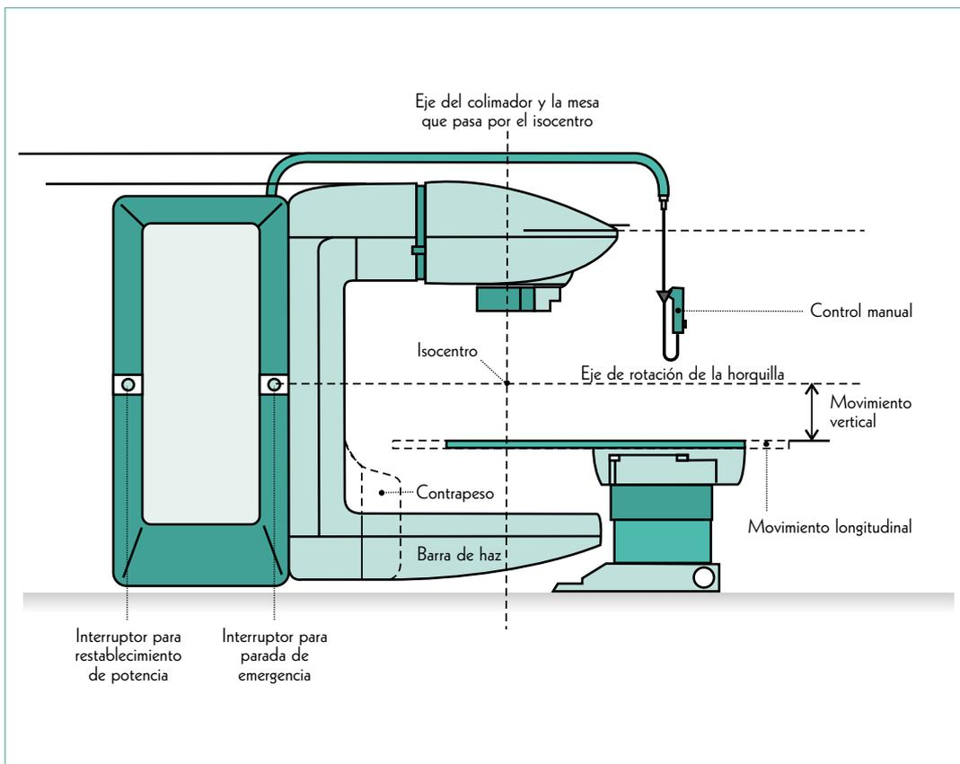
**Figura 7 - Esquema de equipo de cobaltoterapia**
