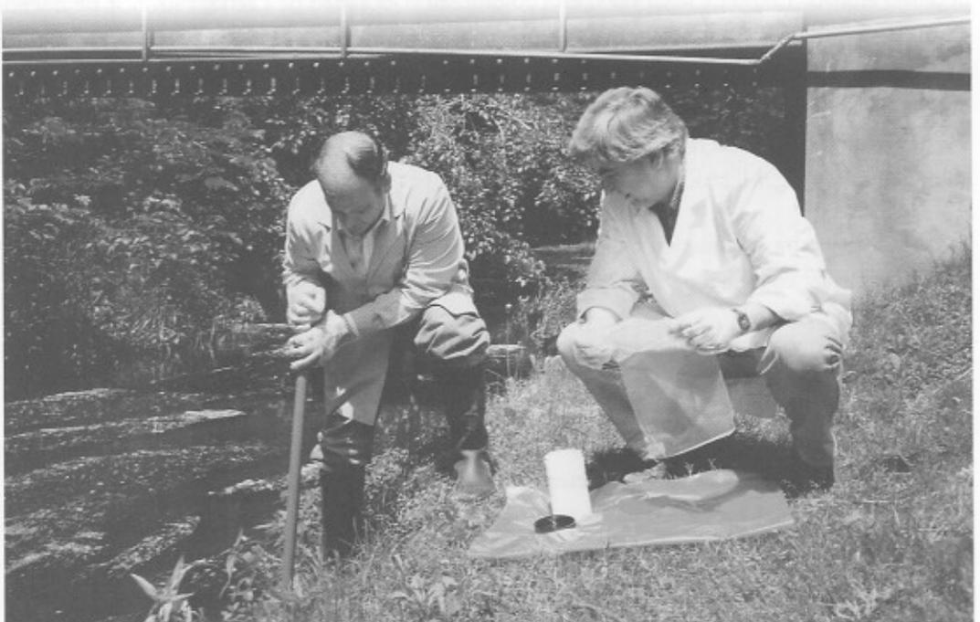
Las muestras de agua y sedimentos del arroyo Aguirre fueron tomadas con una frecuencia mensual, antes y después del CAE (puntos 5, 6, 7, 8 y 9, figura 5). También se analizaron muestras provenientes de los tanques de agua potable de dicho centro (puntos AP1, AP2, AP3 y AP4, figura 5).
