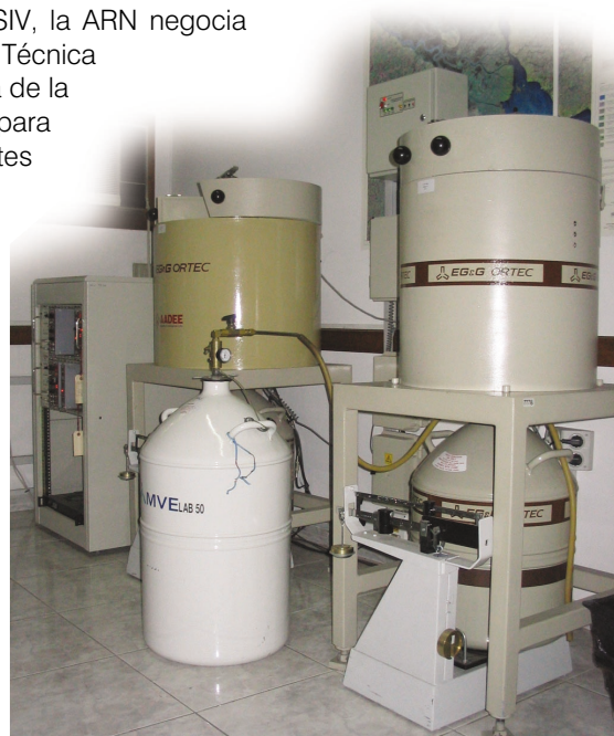
Sistema de medición de la estación monitora de radionucleidos RN01 - Ciudad de Buenos Aires
