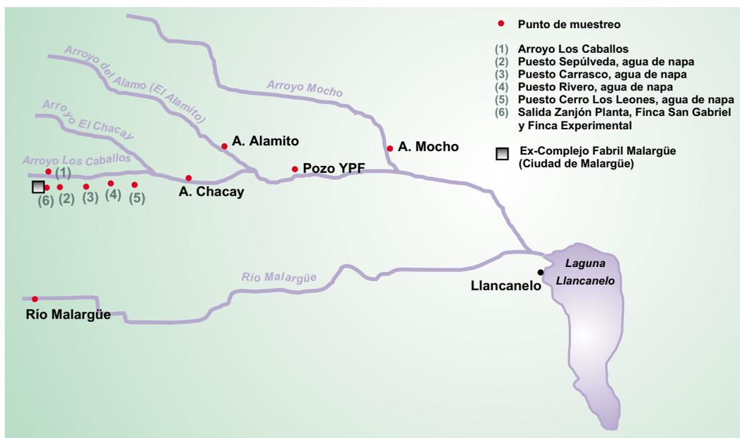
El muestreo ambiental se lleva a cabo fundamentalmente en aguas de napa freática, dado que se encuentra muy alta y aflora en varios puntos en los alrededores de la instalación. Las muestras son recolectadas en distintos puntos aguas abajo en el sentido de escurrimiento de la napa hasta su
