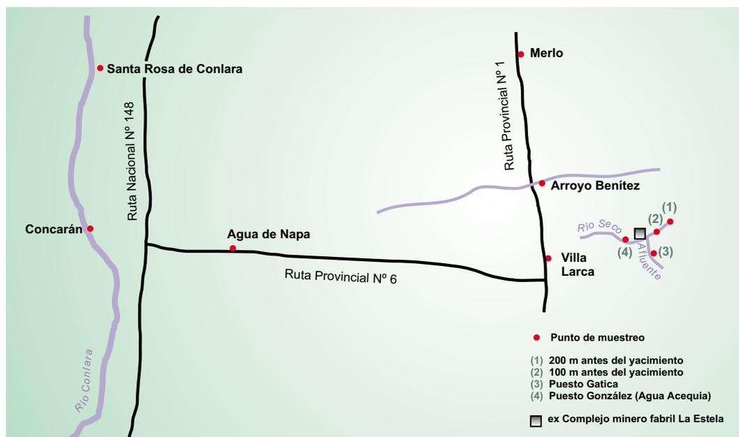
El muestreo se lleva a cabo sobre el río Seco, aguas arriba y abajo del yacimiento y de la planta, tomándose muestras de aguas superficiales y sedimentos. También, se toman muestras de aguas de napa, por la eventual influencia sobre la misma del río Seco y muestras de aguas superficiales y sedimentos sobre el río Conlara, por la eventual influencia sobre éste de las aguas subterráneas.
