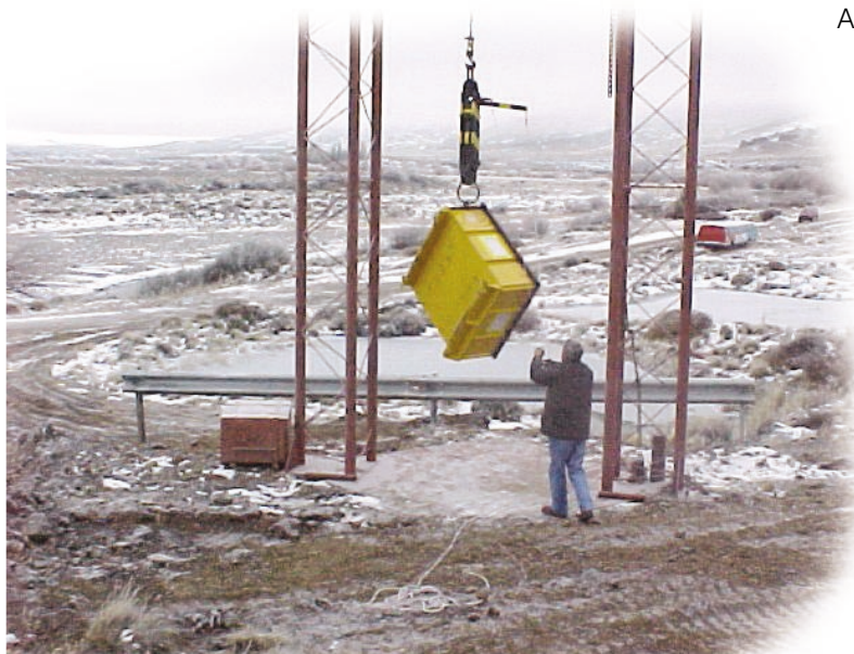
Ensayo mecánico para condiciones accidentales de transporte
