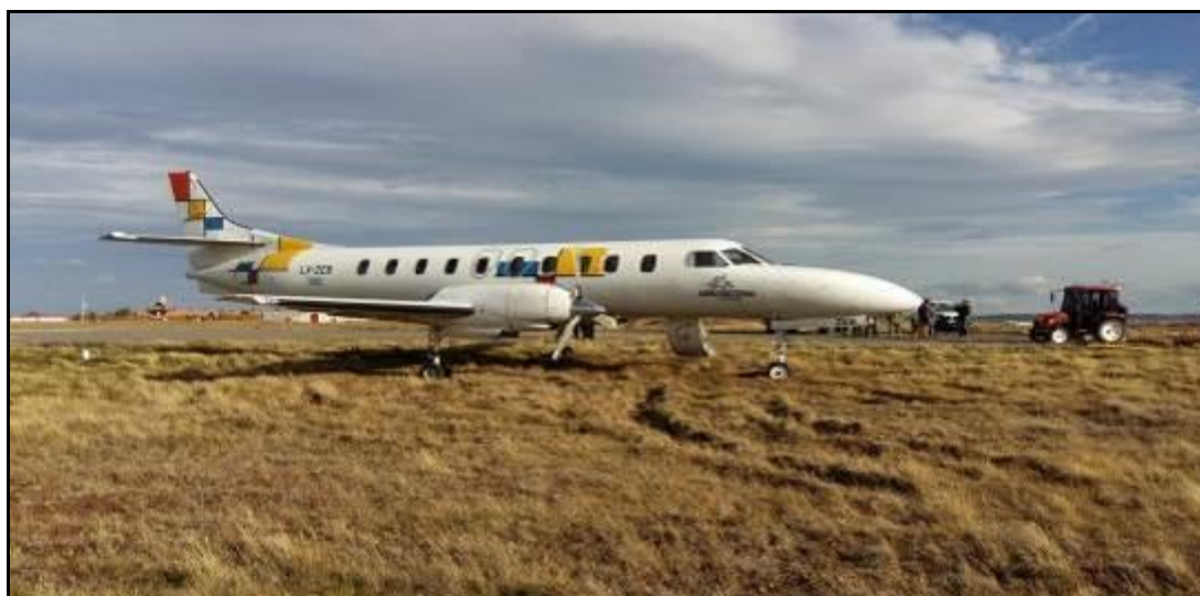
Fig. 5: Vista de la aeronave detenida fuera de la capa asfáltica de la zona de parada
