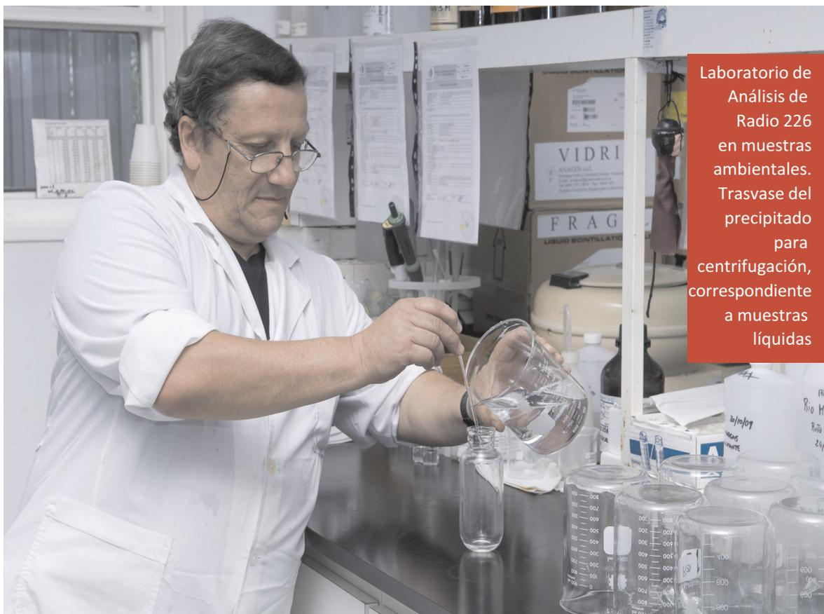
Laboratorio de Análisis de Radio 226 en muestras ambientales. Traslado del precipitado para centrifugación, correspondiente a muestras líquidas
