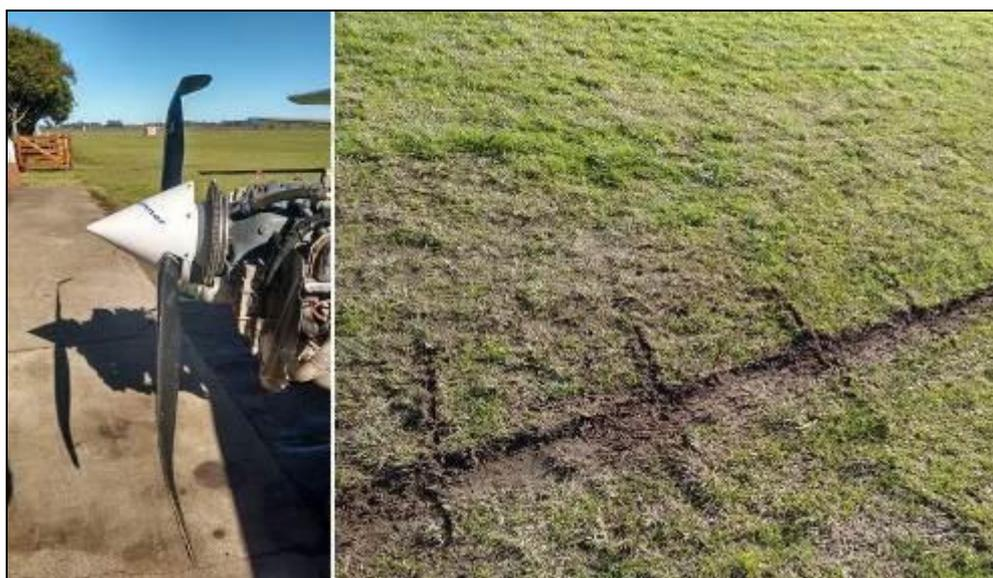
Figura 7. Daños en la hélice e improntas dejadas en el terreno por la misma
