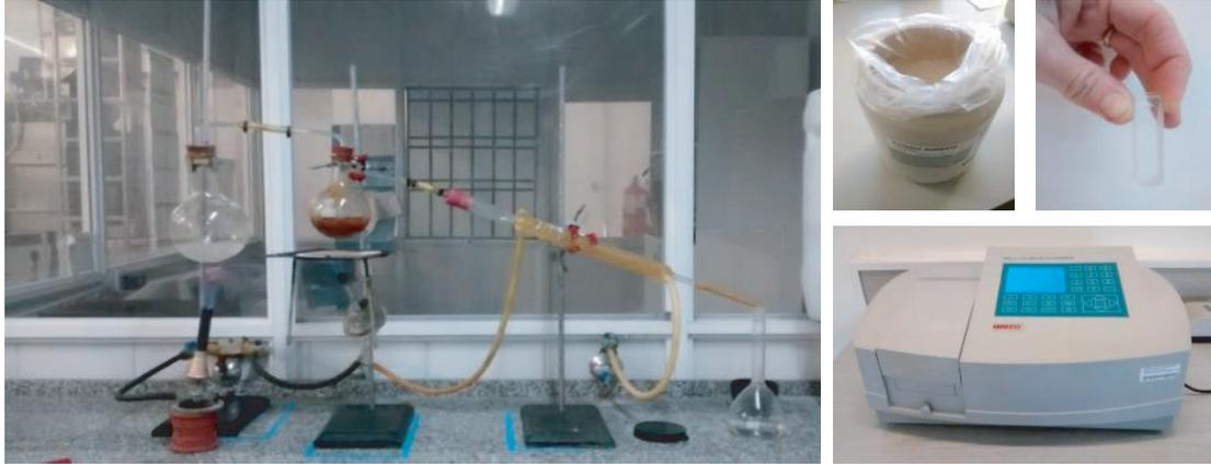
Posteriormente, el sorbato presente en el destilado se determina mediante una lectura espectrofotométrica en el rango UV a 256 nm o por fotocolorimetría o espectrofotometría en el espectro visible (532 nm). En primer lugar, se oxida con ácido crómico y posteriormente se trata con ácido tiobarbitúrico, determinando el color rosado obtenido.
