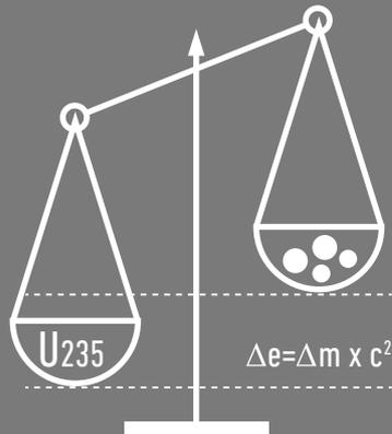
La fisión produce calor y neutrones. En las centrales nucleoelectricas, se aprovecha el calor para producir electricidad. En los reactores de investigación, se aprovechan los neutrones para producir radioisótopos, ensayos de materiales y realizar experimentos.
