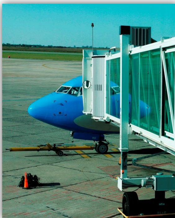
Imagen N°13: Pasarela telescópica. Aeropuerto de Córdoba
