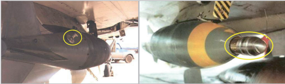
Espoleta MU lateral con retardo de 12 segundos - Espoleta KEMA de nariz para bomba BRP 250
