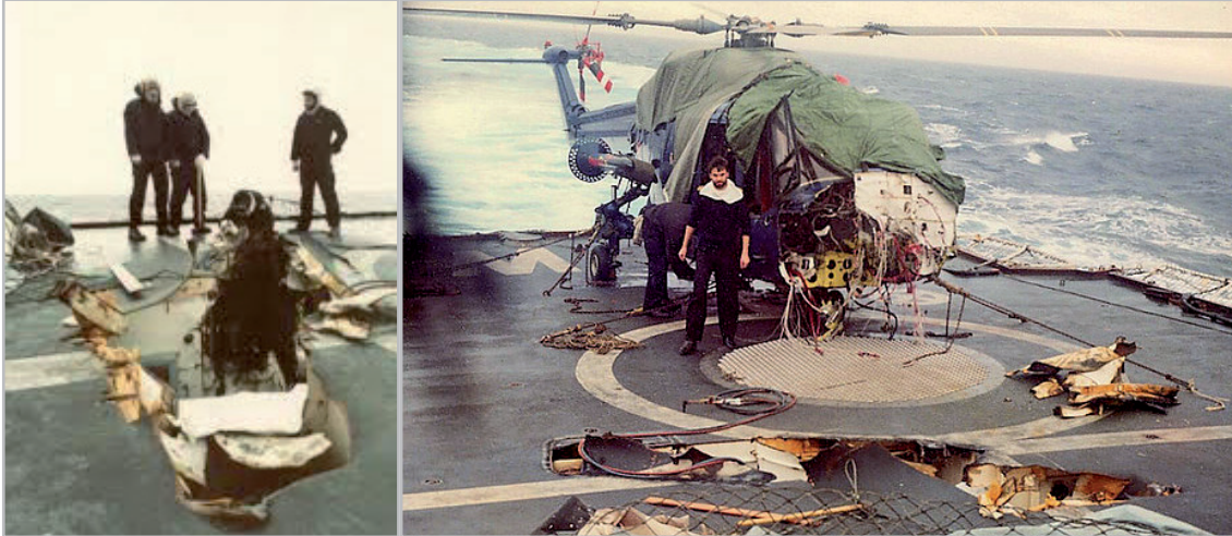
Vista hacia el punto de ingreso de la bomba - Orificio de salida y helicóptero fuera de combate
