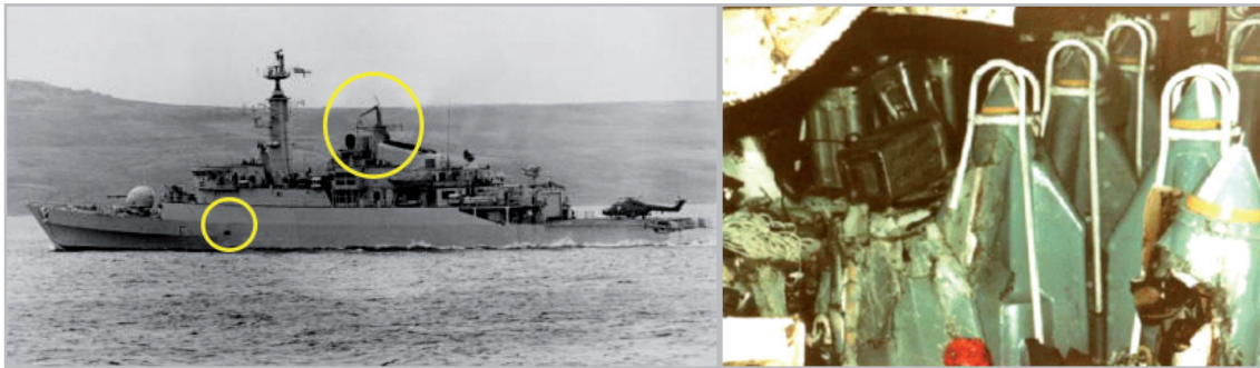
Antena derribada y agujero en la borda de la “Argonaut” - Daños en el depósito de Sea Cat
