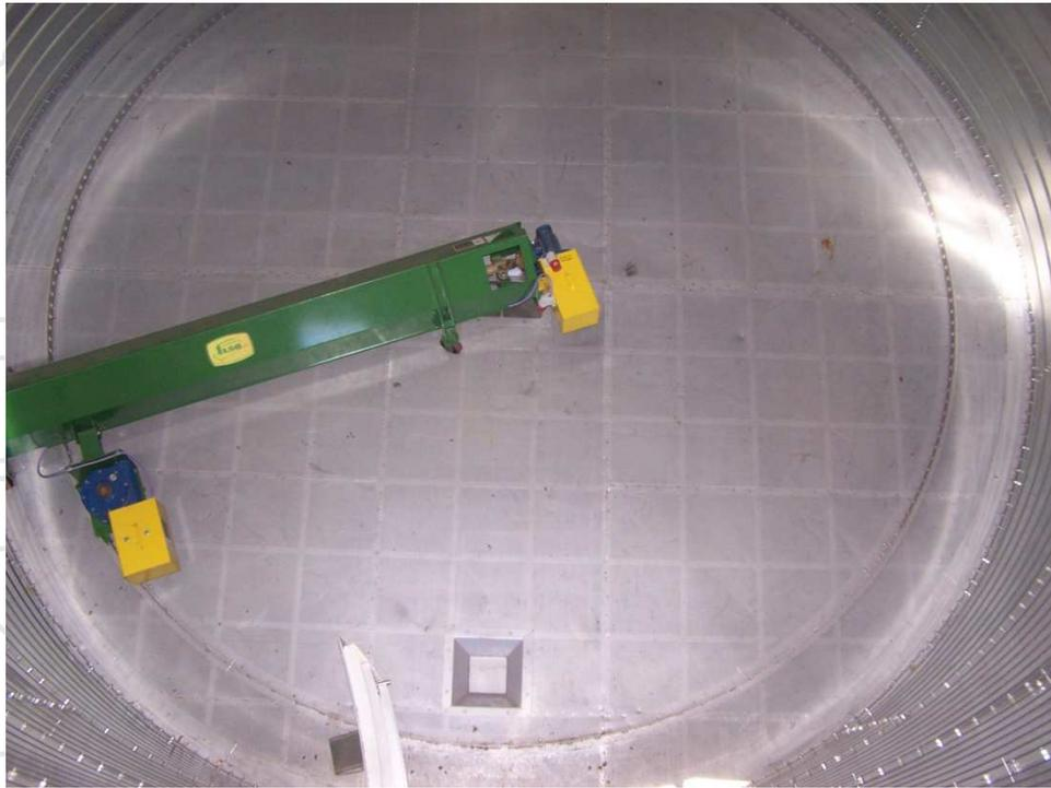
**Figura 3. Vista del piso plano totalmente perforado. También puede verse la rosca barreadora encargada de la limpieza final del silo (opcional).**
