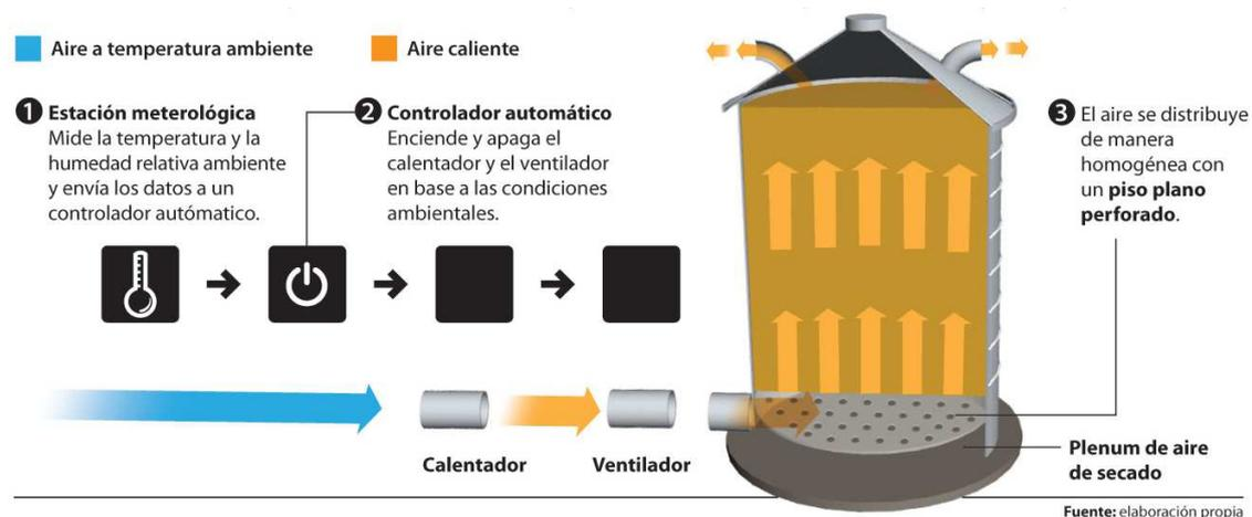
**Figura 2. Esquema del sistema de secado en silo con aire natural / baja temperatura (SSAN/BT).**
