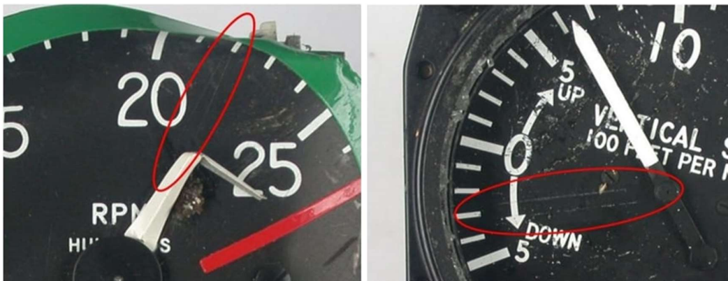
Figura 14. Lectura en los instrumentos de la aeronave posterior al impacto
