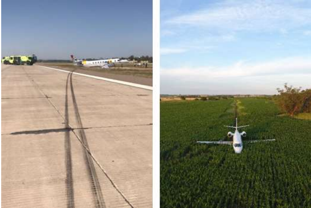
Figura 5. Registro de las marcas dejadas en la pista y en el terreno
