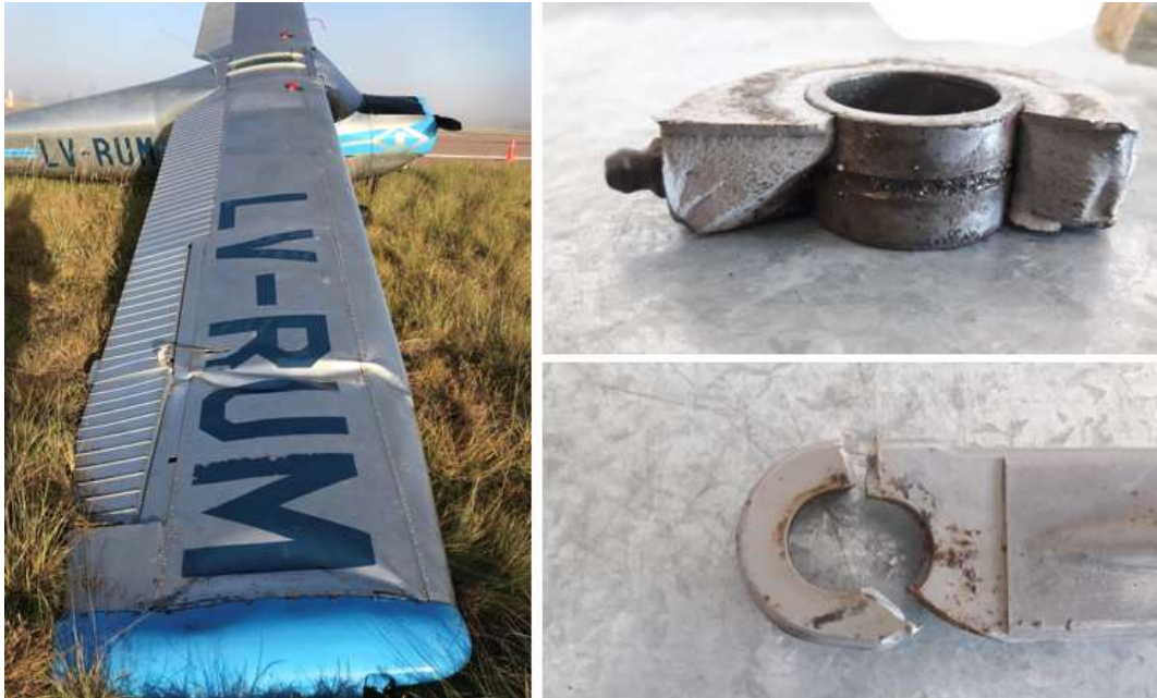
Figura 11. Registro de los daños estructurales y superficies de fractura en componentes
