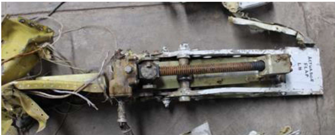
Figura 10. Actuador de un flap
