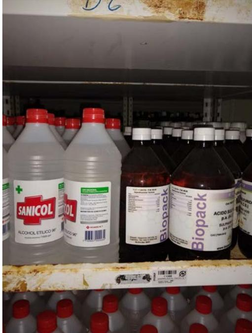
*Como se observa, el alcohol se encuentra junto al ácido sulfúrico, lo cual en principio no sería recomendable.*
