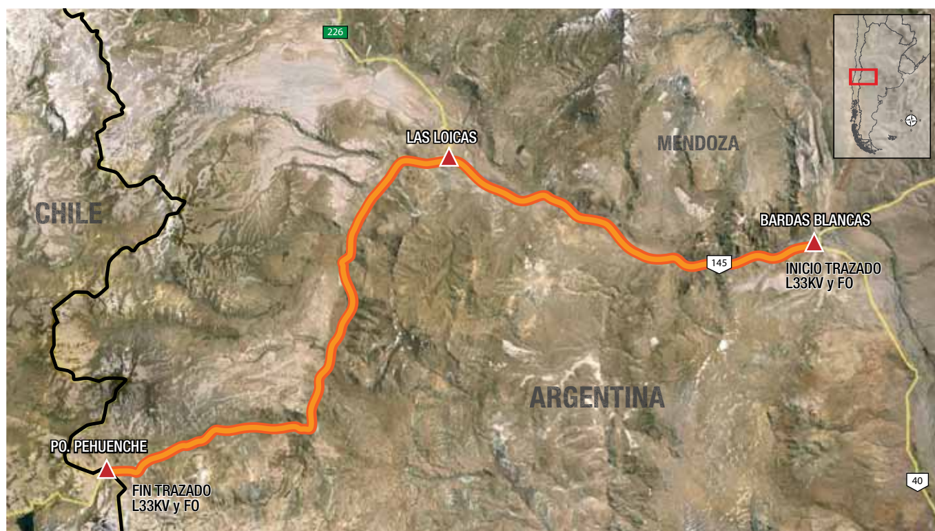
Línea eléctrica 33 KV y fibra óptica
